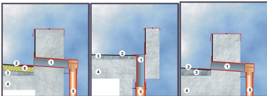
1. Cazoleta salida Lateral EPDM/ 2. Lamina EPDM/ 3. Base para pendiente
